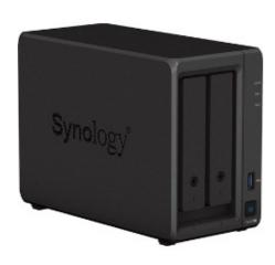
AMD Ryzen R1600 (2×2,6GHz), 16GB, DDR4 - SODIMM, beépíthető meghajtók száma: 2db, 3,5", SATA3 / PCIe NVMe , M.2: 2db, RAID: RAID 0, 1, JBOD, PCI-E x2: 1db, USB3.0: 1db, eSATA, LAN (1Gb/s): 2db, fekete
